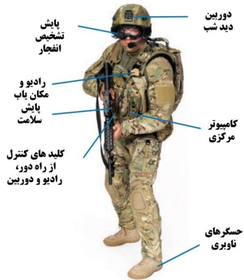
شکل ۲. تجهیزات سرباز مجهز به حسگرهای جمع آوری اطلاعات در نبرد
