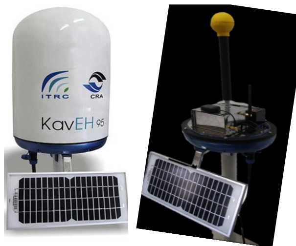
شکل ۱۱. سامانه بومی اندازه‌گیری شدت تشعشعات پرتوهای رادیویی [25]
