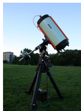
شکل 4: تصویر یک حسگر غیرفعال دوربین با لنز تلسکوپ [24].
