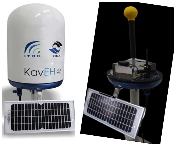
شکل ۱۱. سامانه بومی اندازه‌گیری شدت تشعشعات پرتوهای رادیویی [25]
